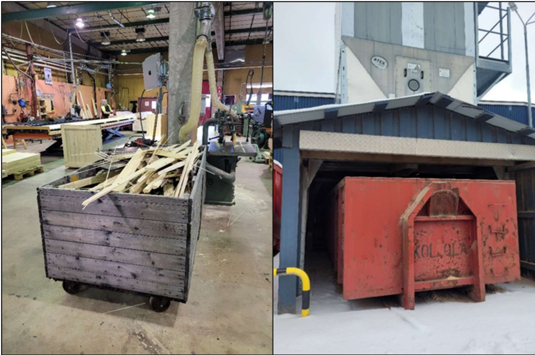
Figur 17. Uppsamling av träspill i lastväxlarcontainer.
