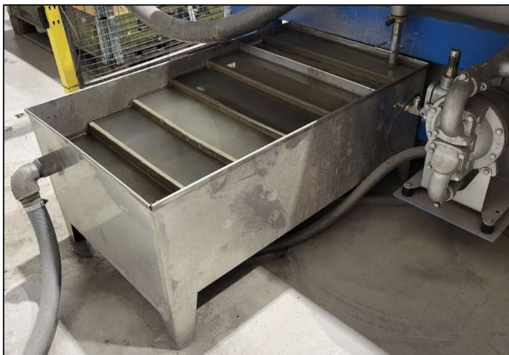
Figur 15. Sedimenteringsbehållare från vattenskrärningen.
